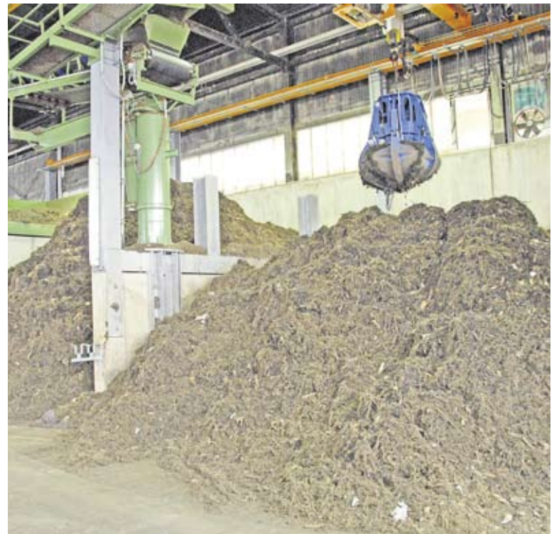
Eine vollautomatische Greifer-Einrichtung beschickt ab einem Zwischen-depot den Fermenter mit zerkleinertem Grüngut.
